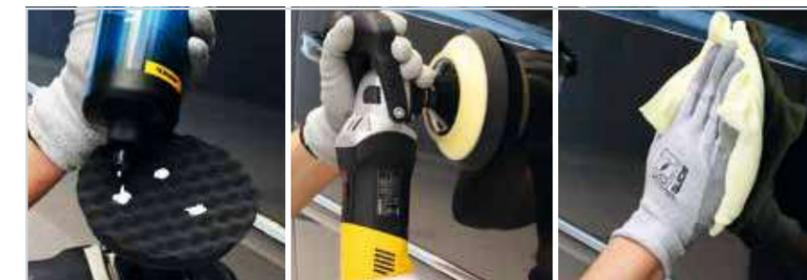
Mousse Golden Finish 2 et Polarshine® 5. Repartir uniformement une petite noisette de pate de lustrage sur la mousse. Lustrer à vitesse reduite entre 800 et 1200 tours/minute.
