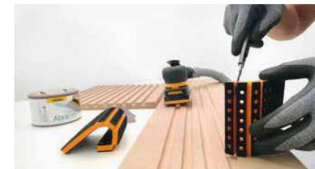
Détacher les segments nécessaires, placer le/les sur le plateau avec une coupe Abranet® et démarrer le ponçage.
